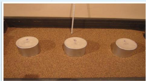
Na montagem de cada coletor, as frações de carvão foram separados interpondo uma fina tela de aço inox e anel (raio interno igual a 4,0 cm) de manta geotêxtil, cortadas no diâmetro interno do coletor (raio e altura iguais a 4,5cm).
