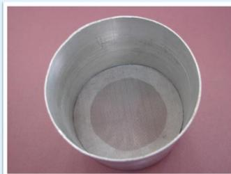
Para não comprometimento das amostragens alguns cuidados foram tomados com o coletor, a saber: sua montagem foi rápida e realizada com carvão isento de <sup>222</sup>Rn e vapor d'água; após as montagens os coletores foram mantidos em estufa a temperatura de 105°C por um período mínimo de 20 h.
